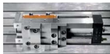
Spanner in seitlicher Aufspannung
